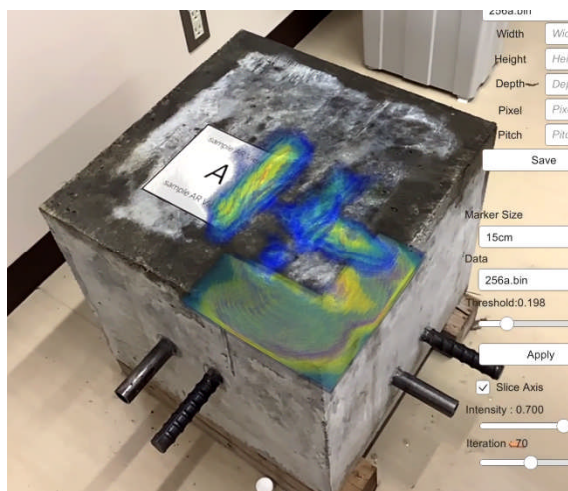
図 6：欠陥イメージング結果の AR 表示。
