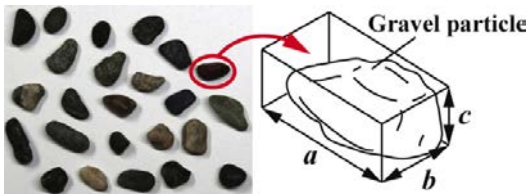
図-9 実験で使用した礫の写真と各径の設定方法
